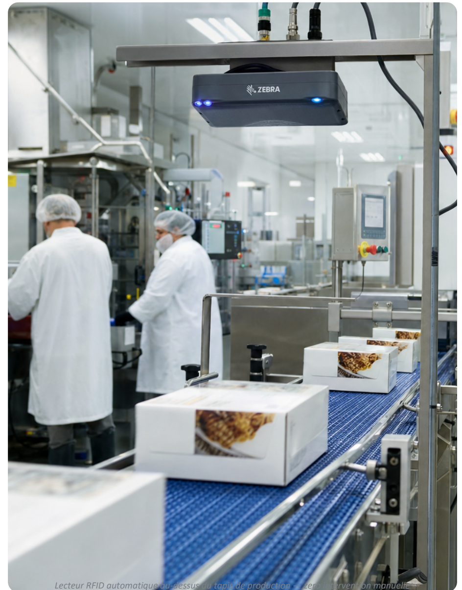
Lecteur RFID automatique au-dessus du tapis de production — zero intervention manuelle.
